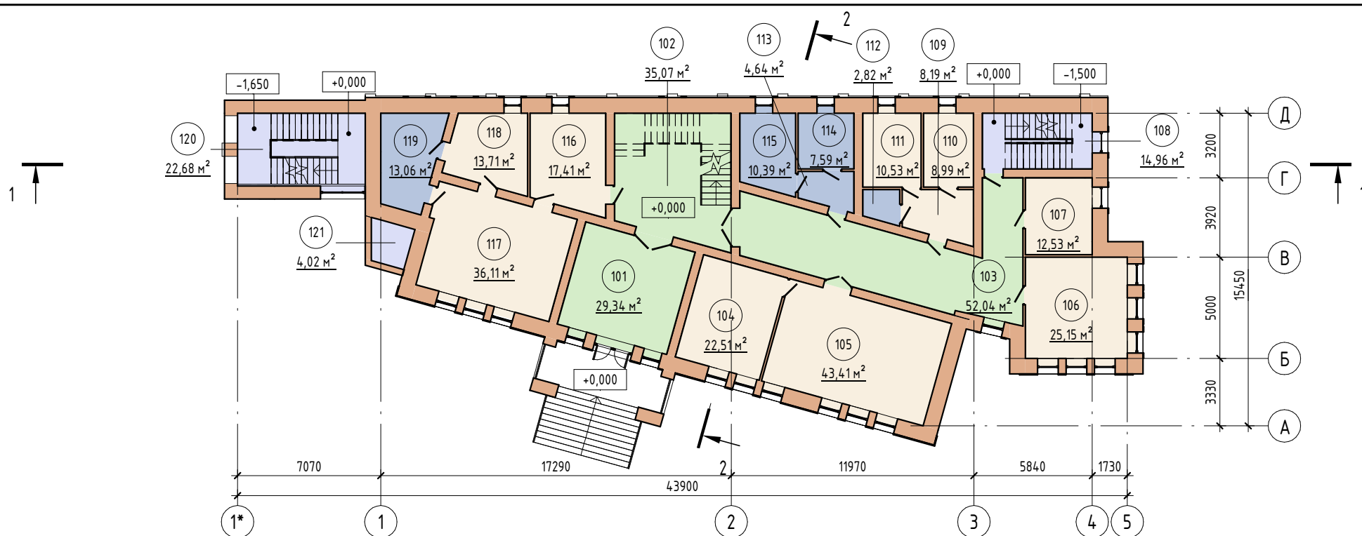
Экспликация помещений первого этажа
