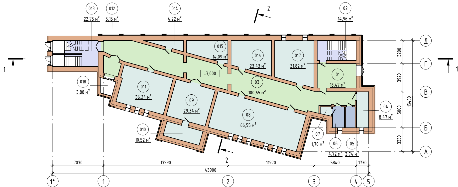
Экспликация помещений цокольного этажа
